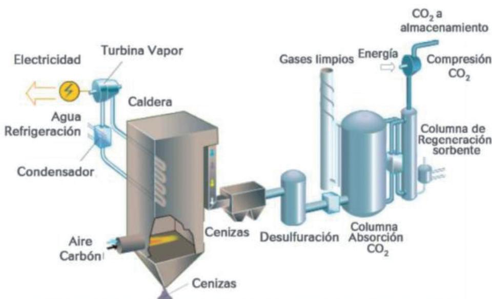
Figura 2: Captura de CO<sub>2</sub> post-combustión (Vattenfall)
