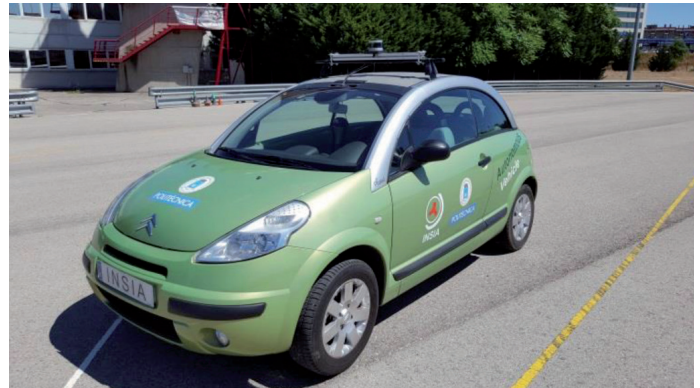
Fig. 1: Vehículo autónomo de INSIA equipado con sensor láser 3D Velodyne VLP-16
