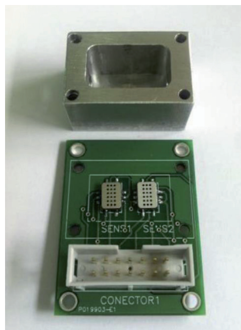
Fig. 2: Montaje en placa de dos sensores SGX Sensortech MiCS-5524, junto a celda de Al fabricada a medida
