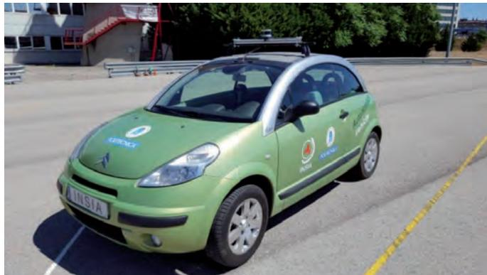
Fig. 1: Vehículo autónomo de INSIA equipado con sensor láser 3D Velodyne VLP-16
