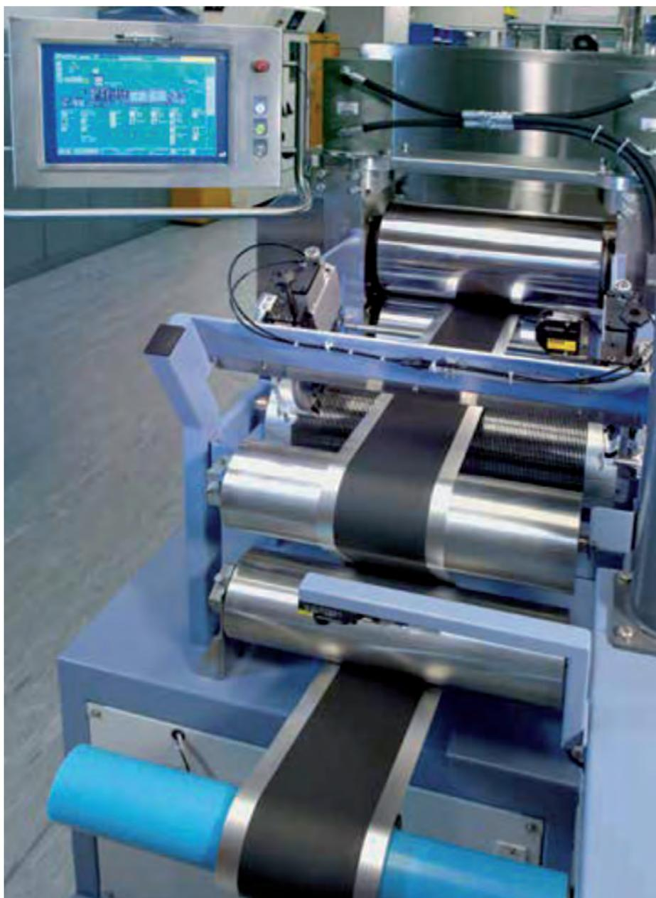
Fabricación de electrodos según la técnica de capas de Fraunhofer-ISIT
