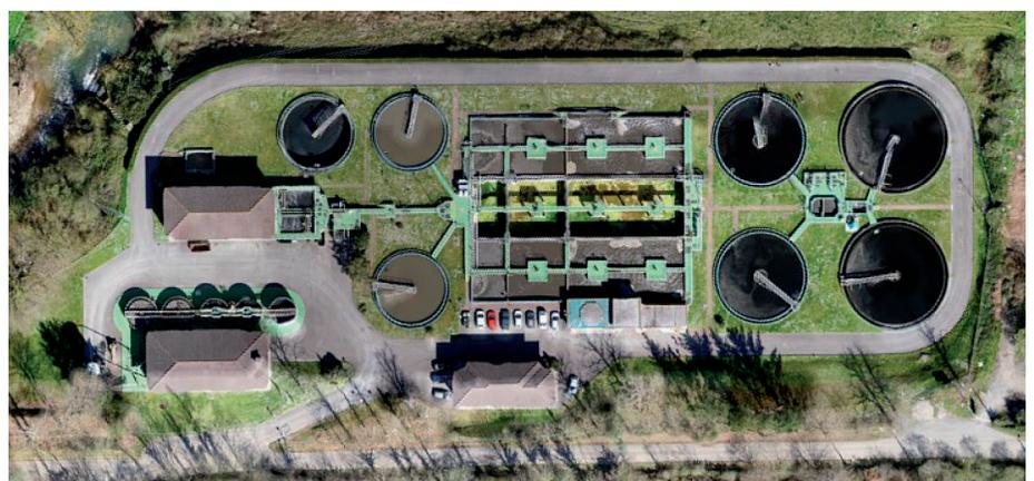
Fig. 1: Vista en planta de la Estación Depuradora de Aguas Residuales. A la izquierda, los dos edificios de desbaste y tratamiento de fangos. Seguidamente tratamientos primario y secundario
