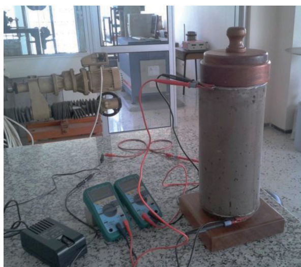
Fig. 1: Medida de la resistividad eléctrica en el hormigón por el método directo (izquierda) y efecto del campo eléctrico sobre los iones disueltos en los poros del hormigón (derecha, imagen adaptada de [1])
